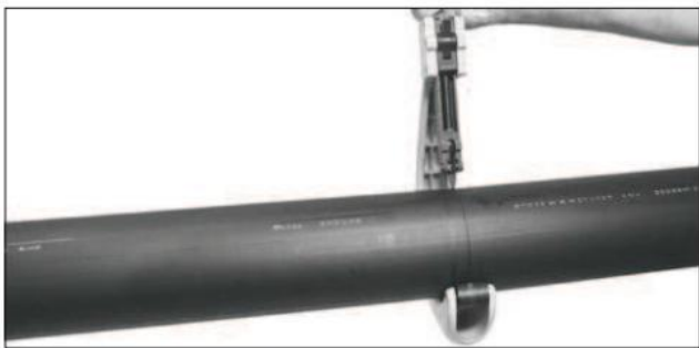
Řez potrubí ruční rotační rezačkou
