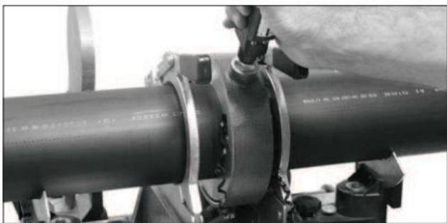
Srovnání konců potrubí integrovaným hoblíkem
